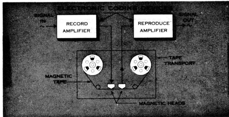
Figure 1.1 BASIC MAGNETIC TAPE RECORDER
